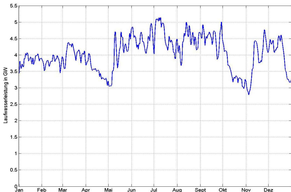
Abbildung 3-4: Simulierte Wasserkraft-Einspeisung für das Jahr 2020 in stündlicher Auflösung (6.5 GW). Quelle: eigene Berechnungen nach BEE-Szenario.
