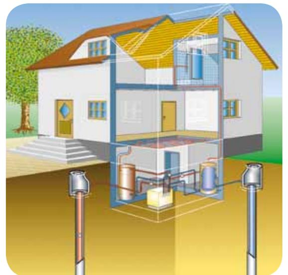
*Grundwasser ist eine hervorragende Wärmequelle für Wärmepumpen.*
