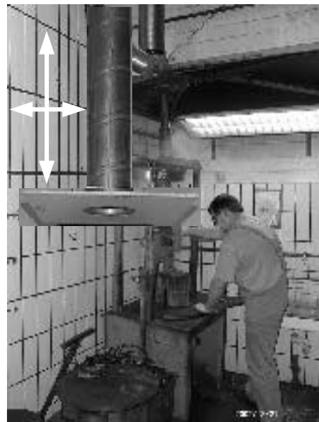
Einströmdüse mit Flansch (frei positionierbar) für den Abbrennarbeitsplatz
