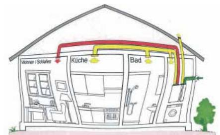
Neubauten sind praktisch "luftdicht"; deshalb ist die Wirkung der Fugenlüftung sehr gering [19].
