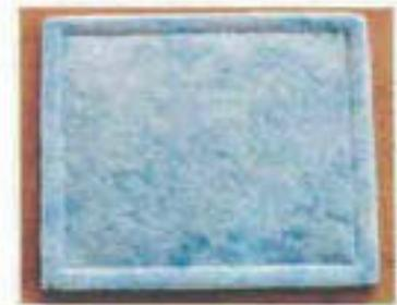
**Neuer Filter einer Wohnungslüftungsanlage [19]**
