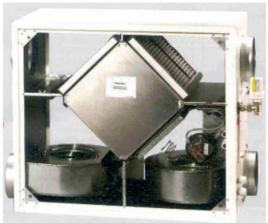
**Die "Innereien" eines Lüftungs-Zentralgeräts: unten Zuluftventilator und Abluftventilator, oben der Kreuzstrom-Wärmeübertrager mit Zuluftfilter und Abluftfilter, rechts die Regelungstechnik. Seitlich sind die Anschlüsse an die Außenluft-, Zuluft-, Abluft- und Fortluftkanäle erkennbar [F9].**
