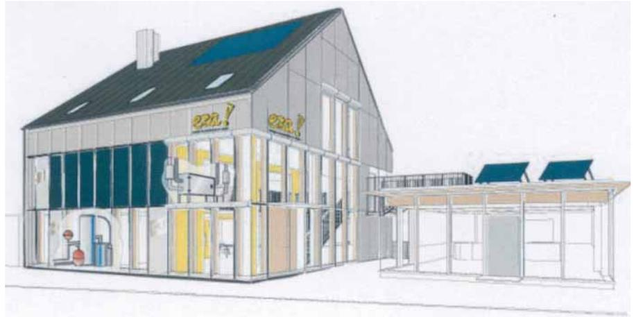
**Grafische Darstellung des eza!-Hauses mit Veranschaulichung einzelner Haustechnik-Bausteine: Lüftungsanlage, Holzpellet-Zentralheizung, Solarkollektoren und Photovoltaikanlage [41]**
