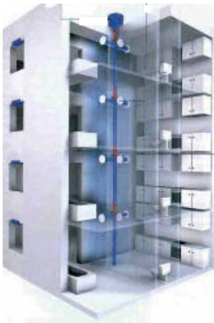
Bei der lüftungstechnischen Sanierung von Mehrfamilienhäusern lassen sich vorhandene Schachtlüftungen bei der Installation von zentralen Abluftsystemen nutzen [F7].
