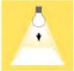
Die Beleuchtungsstärke (E) gibt das Verhältnis des Lichtstroms an, der von einer Lichtquelle auf eine bestimmte Fläche trifft, die Einheit ist lux [lx]. Die Beleuchtungsstärke beträgt 1 lx, wenn ein Lichtstrom von 1 lm auf eine Fläche von 1 m<sup>2</sup> gleichmäßig auftrifft.
