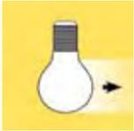
Ist Teil des Lichtstromes, der in eine bestimmte Richtung strahlt. Sie wird in Candela [cd] gemessen.
