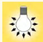
Der Lichtstrom stellt die gesamte von einer Lichtquelle in den Raum abgegebene Strahlungsleistung dar. Die Einheit des Lichtstroms ( $\Phi = \text{phi}$ ) ist Lumen [lm]. Eine Glühlampe (100 W) gibt in etwa einen Lichtstrom von 1.380 lm ab, eine Energiesparlampe (20 W) mit eingebautem elektronischem Vorschaltgerät hat einen Lichtstrom von ca. 1.200 lm.
