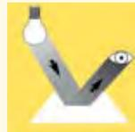
Sie beschreibt den Helligkeitseindruck, den eine Lichtquelle oder eine beleuchtete Fläche dem Auge vermittelt. Die Leuchtdichte L wird in Lichtstärke pro Flächeneinheit angegeben. Für Lampen wird die Einheit Candela pro Quadratcentimeter (cd/cm<sup>2</sup>) verwendet.
