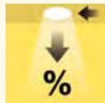
Er gibt das Verhältnis des von der Leuchte abgegebenen Lichtstroms zum Lichtstrom der in der Leuchte eingesetzten Lampen wieder. Einheit: Prozent (%)
