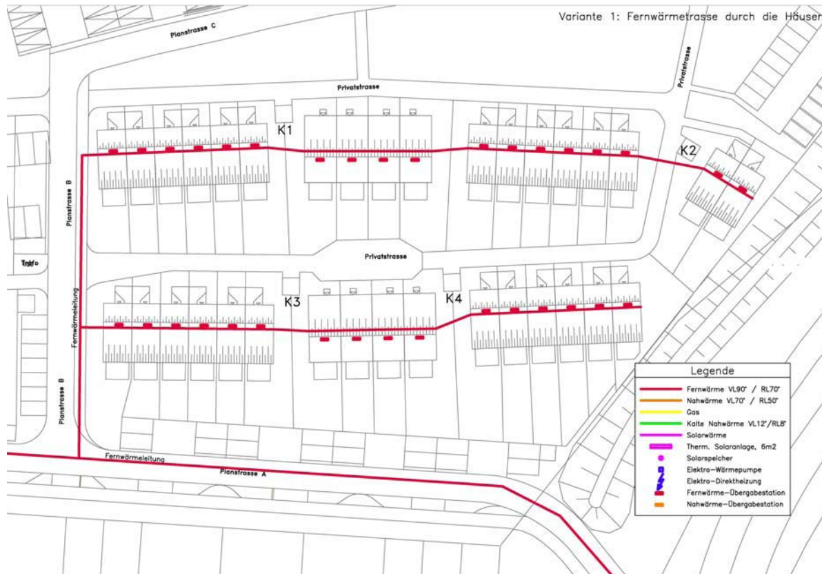
Abbildung 6.26: Variante 1: Fernwärmetrasse durch die Häuser (Quelle: Graw)
