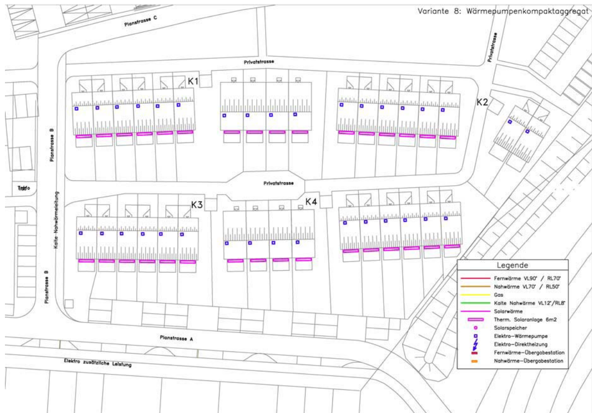
Abbildung 6.34: Variante 8: Einzelenergieversorgung mit Wärmepumpenkompakttaggregat (Quelle: Graw)
