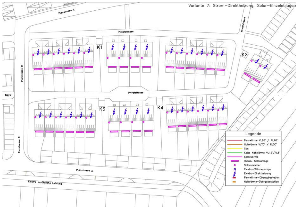
Abbildung 6.33: Variante 7: Einzelenergieversorgung Stromdirektheizung (Quelle: Graw)
