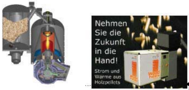
Abbildung 6.12: Mikro-KWK-Technologien auf Basis erneuerbarer Brennstoffe (Pellet-Stirlingmotoren)
