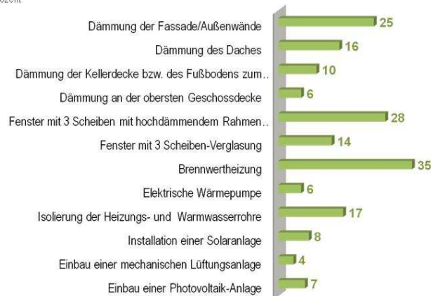
Abbildung 17: Durchgeführte Maßnahmen der energetischen Sanierer
