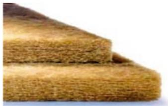
Abb. 19 Dämmmatte aus Flachs
