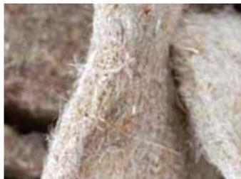
Abb. 20 Dämmfilz aus Hanf
