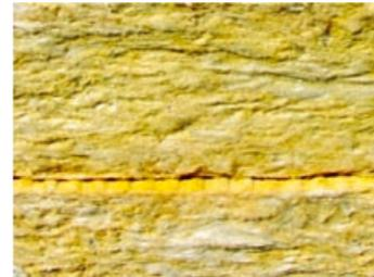
Abb. 6 Mineralfaserdämmstoff
