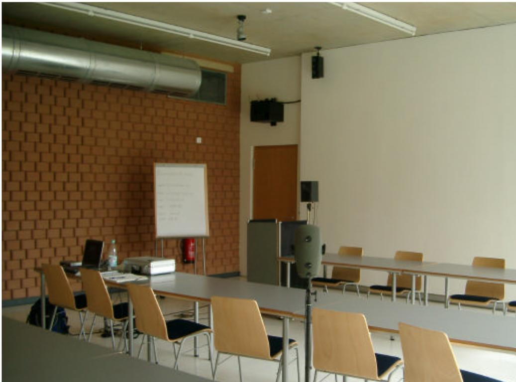
*Grafik 3.2.4 Im Meßaufbau nachgestellte Vortrags-Situation mit 'Vortragendem' am Rednerpult und 'Hörer' in der ersten Reihe. Der Lautsprecher ist auf die Mitte der letzten Sitzreihe ausgerichtet. Die weiße Projektionswand rechts hinter dem 'Vortragendem' ist zugleich ein Plattenabsorber.*
