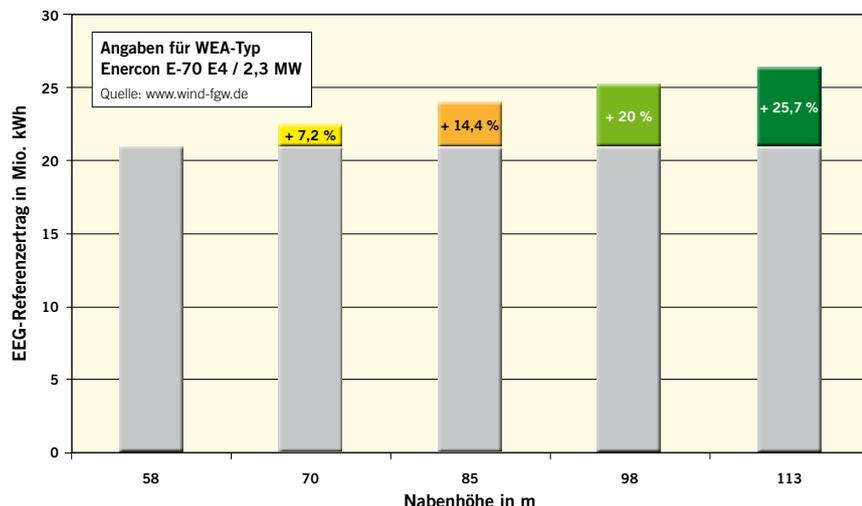
**Abbildung 18:** Einfluss der Nabhöhe auf den Energieertrag – Beispiel: EEG-Referenzenergieertrag (5-Jahres-Energieertrag) des WEA-Typs Enercon E-70 bei verschiedenen Turmhöhen (Quelle: DEWI GmbH)
