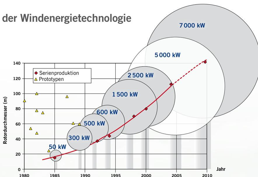
Abbildung 7: Größenentwicklung der Windenergieanlagen seit 1985 (Quelle: DEWI GmbH)
