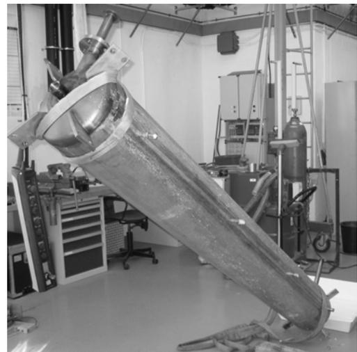
Abbildung 7: Rohrregister nach Aufbringen des ersten PCM/Graphit Segments ohne äußere Behälterhülle(links), Testspeicher beim Einbau in die Versuchsanlage (rechts)
