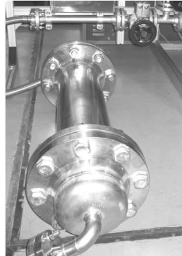
Abbildung 8: Zylinder mit makroverkapseltem mit PCM (links) und nach Einbau in Druckbehälter (rechts)
