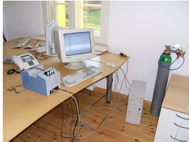
Bild 10: Gasanalysator (SF 6 ), Auswerteeinheit und Gasflasche der Indikatorgas-Messeinrichtung
