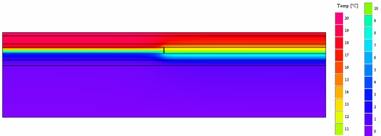
Abb. 3: Für den Querschnitt aus Abb. 1 berechnete Temperaturverteilung. Die Temperaturen T in °C sind gemäß der Farbskala auf der rechten Seite eingetragen.
