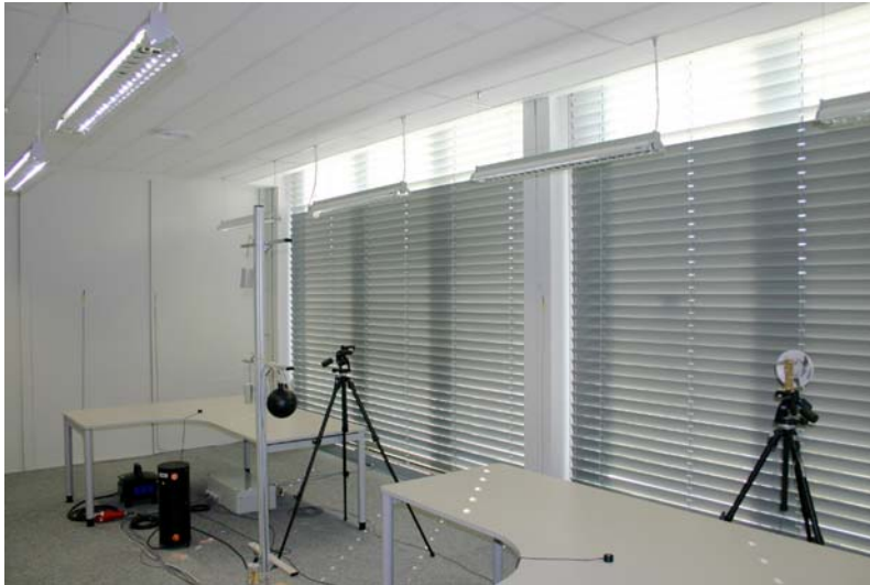
Bild 6 Innenansicht eines Versuchsraumes mit vollverglaster Fassade und innenliegendem Sonnenschutz.
