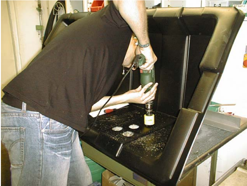
Abb. 3: Bohren der Lüftungslöcher
