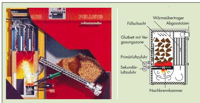
**Abb. 8** Schnitt durch einen Pelletheizkessel [ hier mit manuell zu füllendem Vorratsbehälter für ca. einen Monatsbedarf (a) und ein Scheitholzheizkessel (b)
