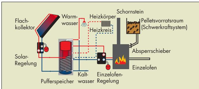
**Abb. 10** Beispiel für die Kombination von Pelletofen mit einer Kollektoranlage [Quelle: Wodtke GmbH Tübingen, Biomasse Info-Zentrum]
