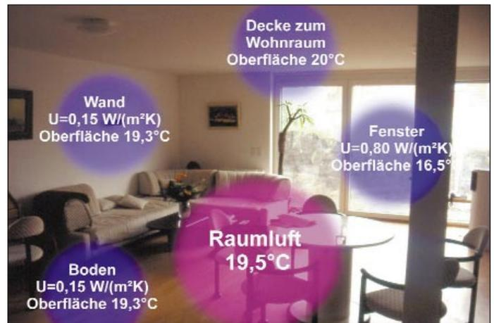
**Abb. 3** Gute Dämmung: Trotz niedrigerer Raumlufttemperatur nur geringe Unterschiede in der Wärmeverteilung im Raum. Angenehme Wohnbehaglichkeit. [Quelle: Schulze Darup, s. S. 4]
