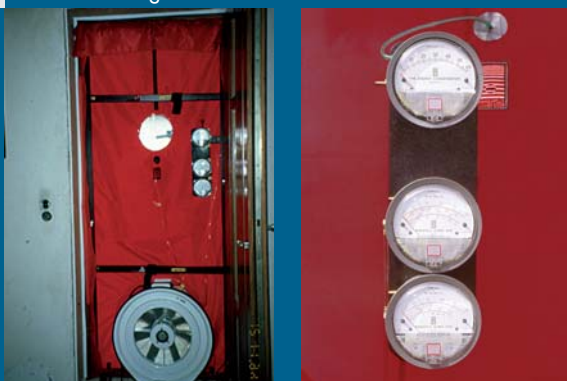
Messeinrichtung für den Blower-Door-Test
