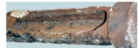
Bild 5.6: Der Rückstau im Abwasserrohr erhöht den Innendruck. In dieser Situation kommt es bei oft mehrere Jahrzehnte alten Abwasserleitungen, die dieser Extremsituation nicht gewachsen sind, zu Rohrbrüchen.
