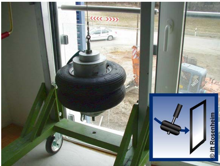
Bild 1 Prüfrahen mit Stoßkörper – Pendelschlagversuch vor Ort entsprechend EN 12600 [2]
