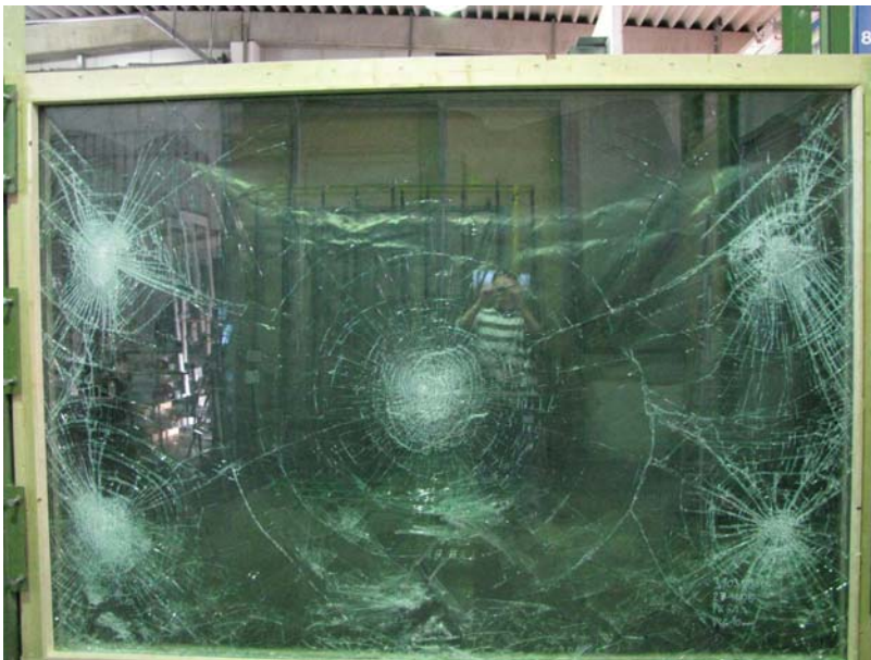
Bild 2 Beispiel belastete Probe, Abmessung 2100 mm x 3000 mm
