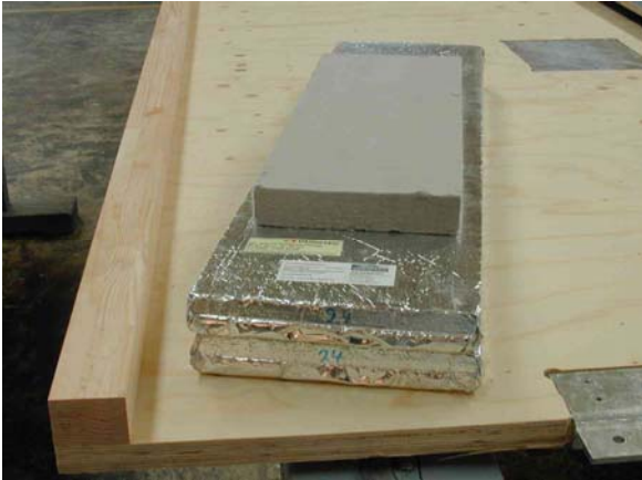
Abbildung 7.3-1 Zwei kleine Vakuum-Isolationspaneele (übereinander liegend), darauf das Kernmaterial aus pyrogener Kieselsäure
