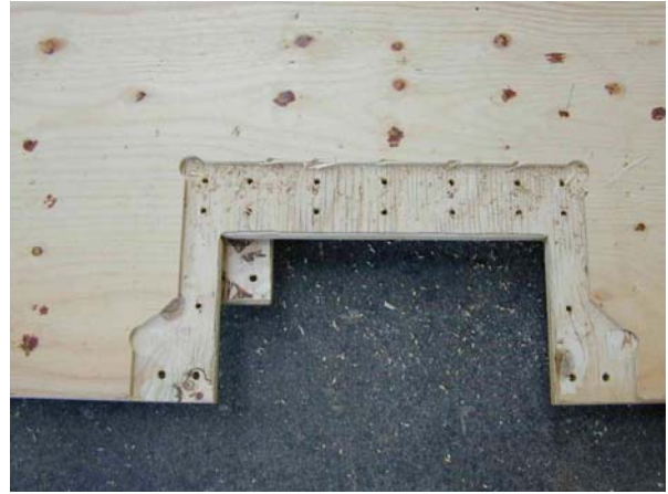
Abbildung 7.3-4 Ausfräsungen für Metallbeschläge an BFU- (links) und Kerto-Platten (rechts)
