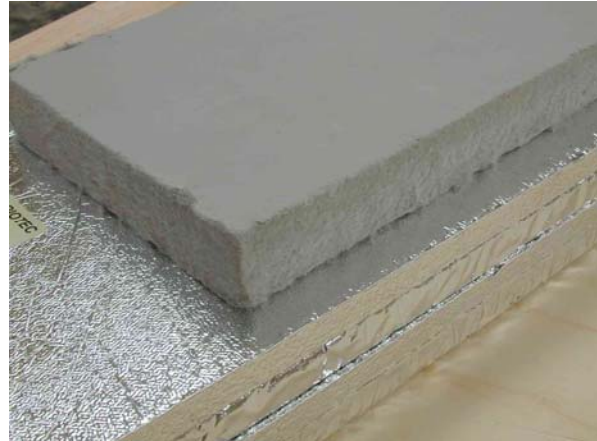
Abbildung 7.3-1 Zwei kleine Vakuum-Isolationspaneele (übereinander liegend), darauf das Kernmaterial aus pyrogener Kieselsäure
