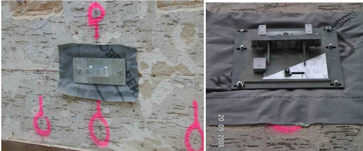
Abbildung 7.4-6 Ansicht montierter Befestigungspunkte: links W-Punkt, rechts E-Punkt
