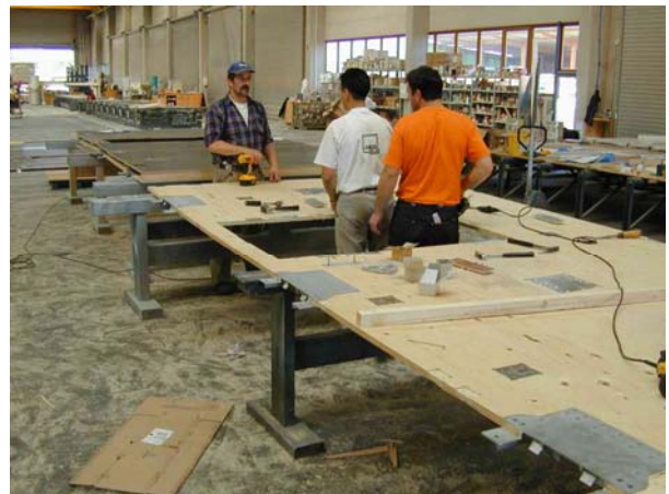
Abbildung 7.3-6: Einbau der Metallbeschläge in die Kerto-Platte
