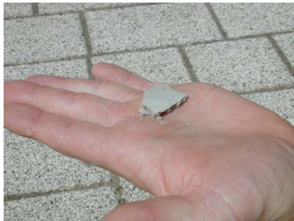
Schmutz aus den Ventilatorschaufeln
