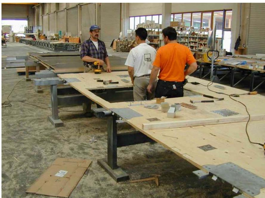
**Abbildung 3.1-10: Einbau der Metallbeschläge in die Kerto-Platte**
