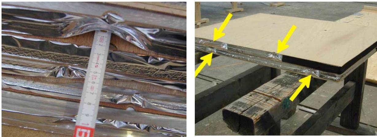
**Abbildung 3.1-6: Aussparungen an den VIP-Rändern für die spätere Durchführung von Befestigungsankern**
