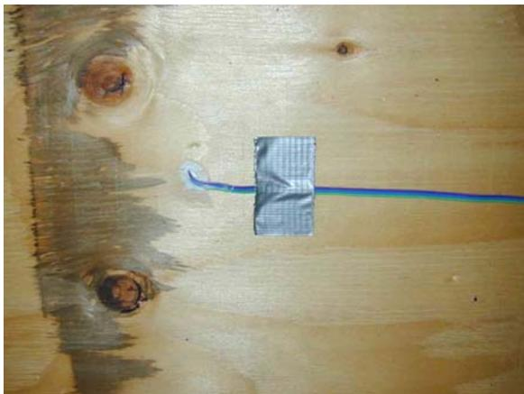
Der Temperaturfühler wird in die Kerto-Platte eingeklebt und fixiert.
