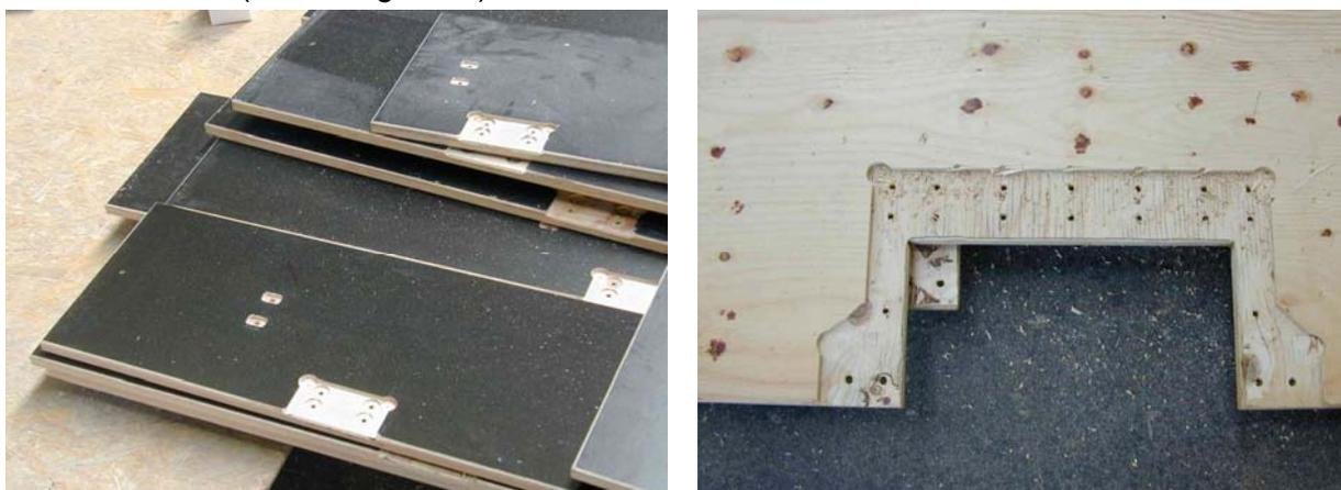
**Abbildung 3.1-8: Ausfräsungen für Metallbeschläge an BFU- (links) und Kerto-Platten (rechts)**
