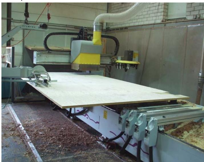
**Abbildung 3.1-7: Bearbeitung der Kerto-Platte mit CNC-Fräsmaschinen**
