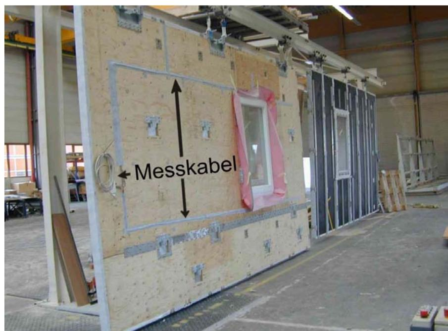
**Abbildung 3.1-25: Ansicht eines fertigen GEDT-Elements (Wandseite) und der Messtechnik**
