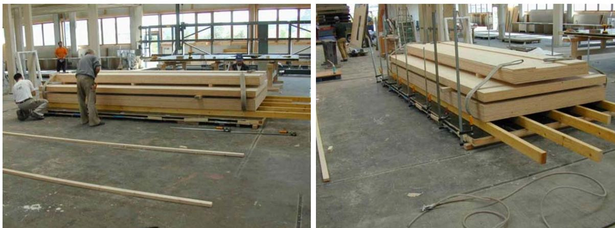
**Abbildung 3.1-19: GEDT mit Gewichten während des Aushärtens des Klebers**
