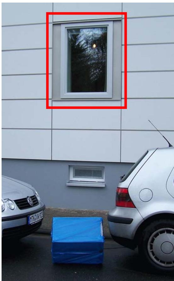
**Abbildung 5.2-1: Messung der Luftschalldämmung Fensterelement, Prüfelement rot umrandet**
