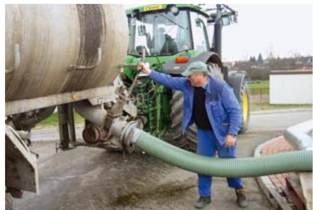
Abb. 15: Anlagenführer Jörn Weitemyer bei der Beschickung der Vorgrube mit Gülle
