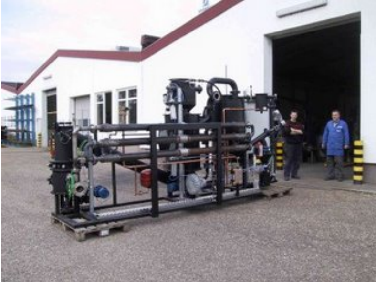
Abbildung 21: Holzvergaser Baugruppe eines 30 kW el BHKW-Moduls der Spanner RE GmbH, Stand Herbst 2008, Darstellung bereitgestellt vom Hersteller
