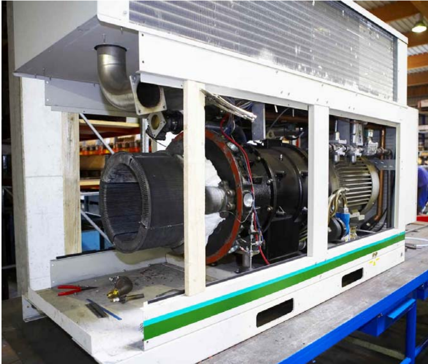
Abbildung 22: Aufnahme eines Stirlingmotors mit Blick auf den Wärmeübertragerkopf, Darstellung bereitgestellt von Qalovis
