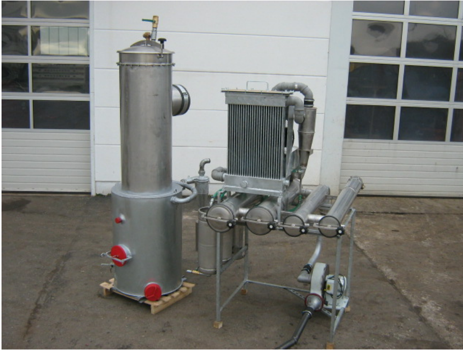
Abbildung 20: Vergaser und Gasreinigungsteil für ein Holzgas-BHKW Fabrikat Gräbner, bereitgestellt von Hans Gräbner jun.
