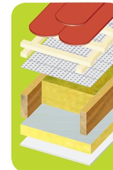
>> Altes Sparrendach mit 8x16 cm Sparren, dazwischen Mineralwollendämmung, Dämmqualität (WLS) 035, darunter 6 cm Polyurethandämmung mit beidseitiger Metallkaschierung, Dämmqualität (WLS) 024
