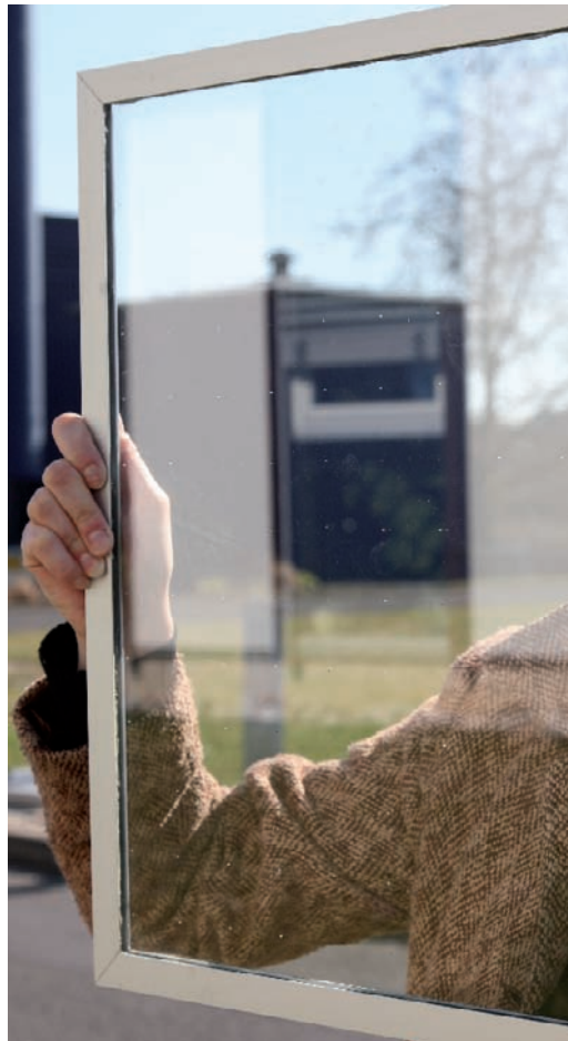
Abbildung 3 Blick durch ein Vakuumisolierglas (Prototyp VIG) mit U_g = 0,5 \text{ W}/(\text{m}^2\text{K})
