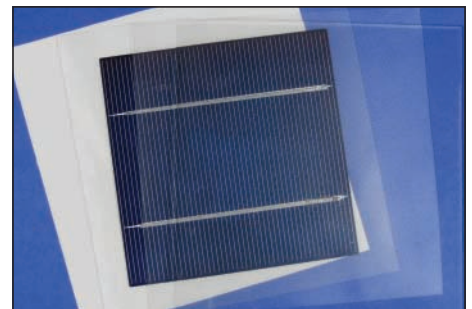
23 In einem Standard-Solarmodul verwendete Materialien. V.r.n.l.: eisenarmes Glas, EVA, Solarzelle, EVA, Rückseitenfolie (Quelle: Fraunhofer ISE)
