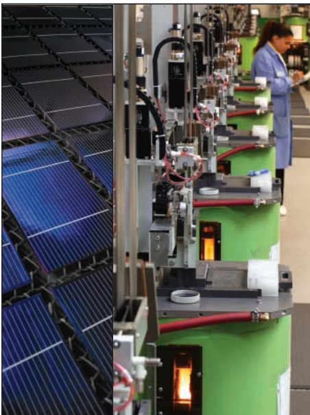
14 Kostengünstige Wafer II: Anlagen für flächig gezogenes Silizium nach dem String-Ribbon-Verfahren und fertige Solarzellen (Quelle: Evergreen Solar)
