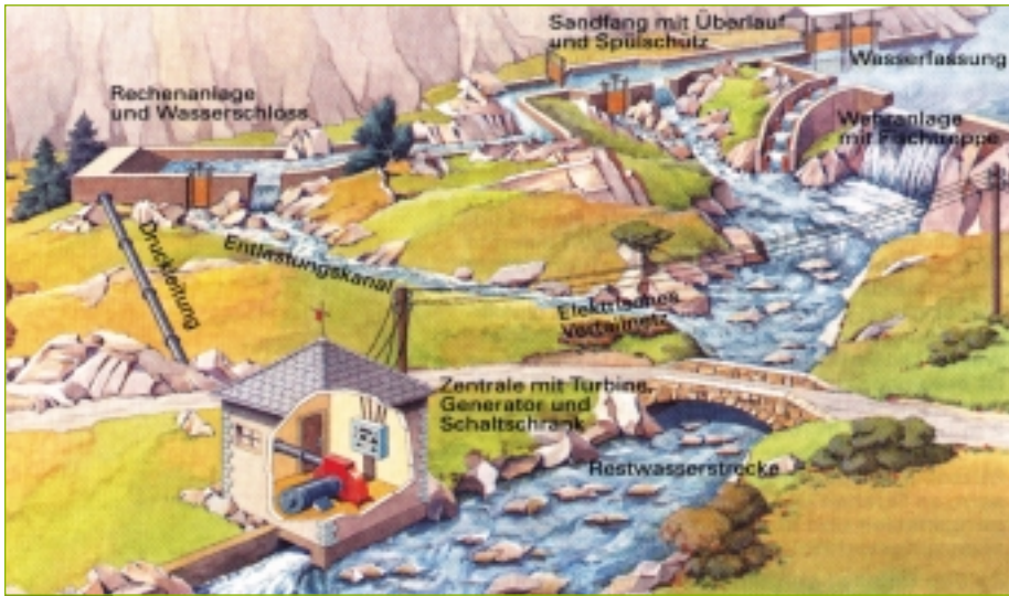
Abb. 6 Schema eines Hochdruckkraftwerks mit Seitenkanal. Im Unterschied zur Darstellung würde man heute die Durchlässigkeit für Fische und andere Tiere durch eine Fischaufstiegsanlage in Form eines speziellen Seitenkanals ermöglichen. [Quelle: Bundesamt für Konjunkturfragen]
