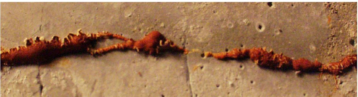
Bild 10.49: Detailaufnahme der Ausblühungen entlang eines Risses nach einem Permeabilitätsversuch bei 80 °C ( $I = 100 \text{ mWs/m}$ ) Bildbreite ca. 4 cm
