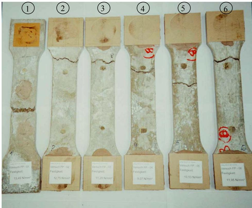
Bild A 3.1.7: Versuchskörper 1 ÷ 6 nach dem Bruch (Seite B)
