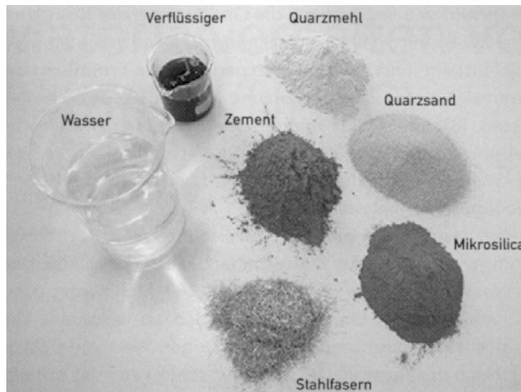
Bild 2.6: Mischungsbestandteile eines faserbewehrten ultrahochfesten Feinkornbetons
