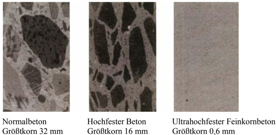
Bild 2.2: Vergleich der Zuschläge von Normalbeton, hochfestem Beton und ultrahochfestem Feinkornbeton [Schneider und Horvath (2000)]
