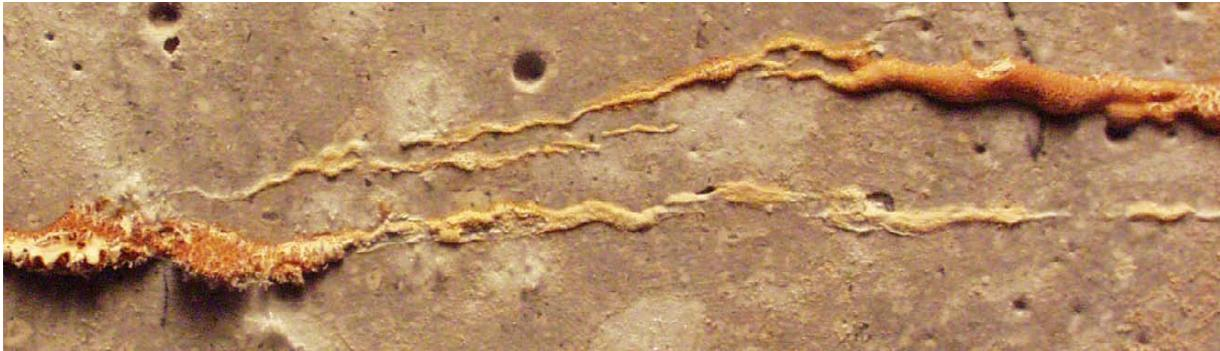
Bild 10.44: Ausblühungen entlang eines Risses nach einem Permeabilitätsversuch bei 80 °C ( $I = 100 \text{ mWs/m}$ ) Breite des Bildausschnittes ca. 8 cm
