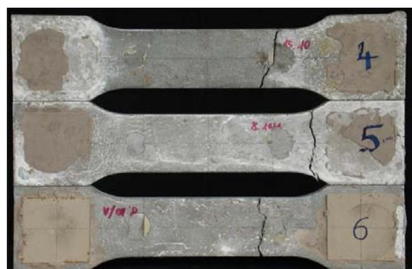
Bild A 3.2.23: Flachproben nach zentrischem Zugversuch
