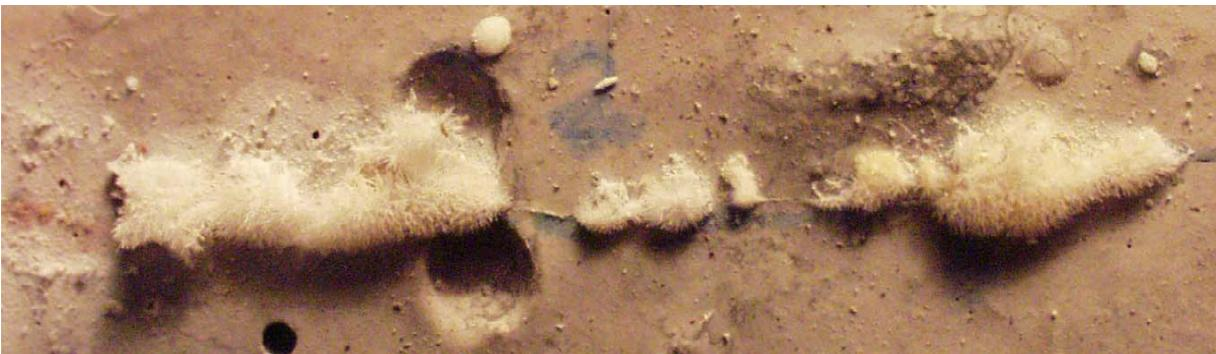
Bild 10.48: Detailaufnahme der Ausblühungen entlang eines Risses nach einem Permeabilitätsversuch bei 80 °C ( $I = 100 \text{ mWs/m}$ ) Bildbreite ca. 4 cm
