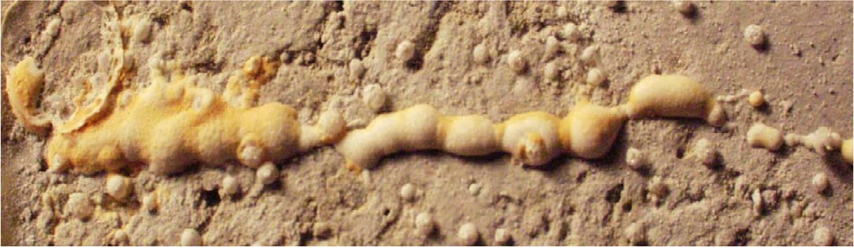
Bild 10.46: Ausblühungen entlang eines Risses nach einem Permeabilitätsversuch bei 80 °C ( $I = 100 \text{ mWs/m}$ ) Bildbreite ca. 8 cm
