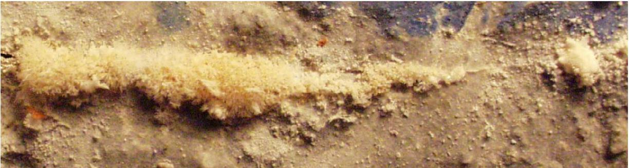
Bild 10.47: Ausblühungen entlang eines Risses nach einem Permeabilitätsversuch bei 80 °C ( $I = 100 \text{ mWs/m}$ ) Bildbreite ca. 4 cm
