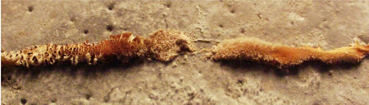
Bild 10.42: Ausblühungen entlang eines Risses nach einem Permeabilitätsversuch bei 80 °C ( $I = 100 \text{ mWs/m}$ ) Breite des Bildausschnittes ca. 5 cm
