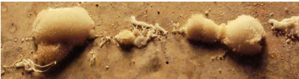
Bild 10.45: Detailaufnahme der Ausblühungen entlang eines Risses nach einem Permeabilitätsversuch bei 80 °C ( $I = 100 \text{ mWs/m}$ ) Bildausschnitt ca. 4 cm
