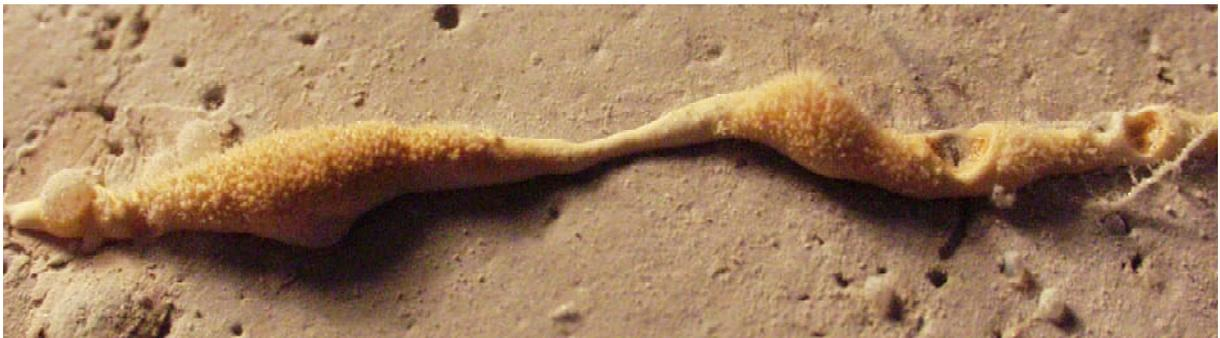
Bild 10.43: Ausblühungen entlang eines Risses nach einem Permeabilitätsversuch bei 80 °C ( $I = 100 \text{ mWs/m}$ ) Breite des Bildausschnittes ca. 4 cm
